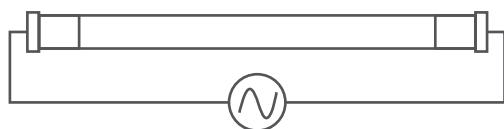
1灯式 両側給電の配線図
